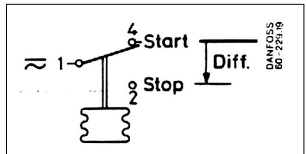
Рис. 3. Включения клемм 1 и 4.
